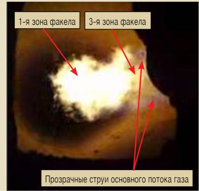
Рис. 4. Факел трехступенчатого сжигания природного газа горелкой «MAS»
